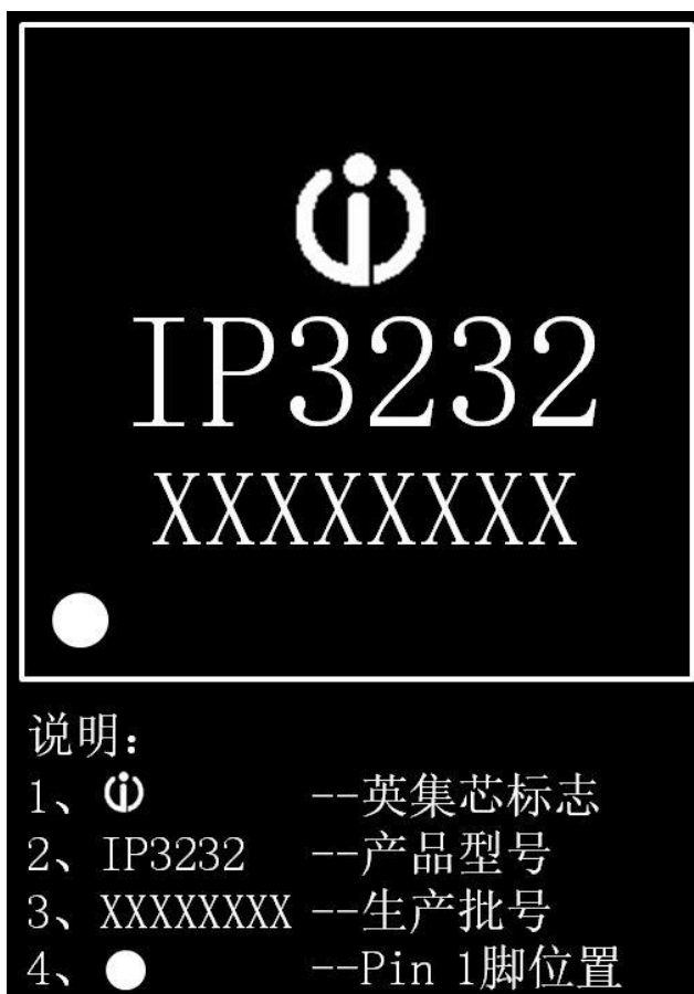
图 11: IP3232 IC 丝印说明
